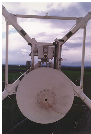
Fig. 3.2 : Scatola che contiene i 3 feeds in fuoco primario
