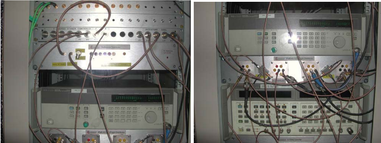
Fig. 4.3 : Distributori : segnale di riferimento (a sinistra) e oscillatore locale (a destra)
